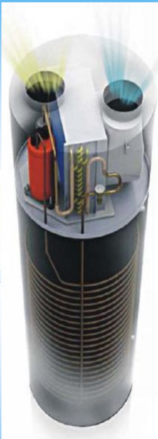
бак выполнен из стали 304, алюминиевый конденсатор находится снаружи емкости что исключает контакт с нагреваемой горячей водой
