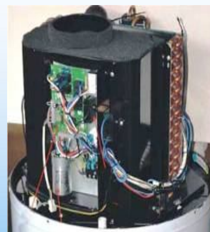
бак выполнен из стали 304, алюминиевый конденсатор находится снаружи емкости что исключает контакт с нагреваемой горячей водой
