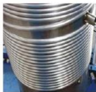
бак выполнен из стали 304, алюминиевый конденсатор находится снаружи емкости что исключает контакт с нагреваемой горячей водой
