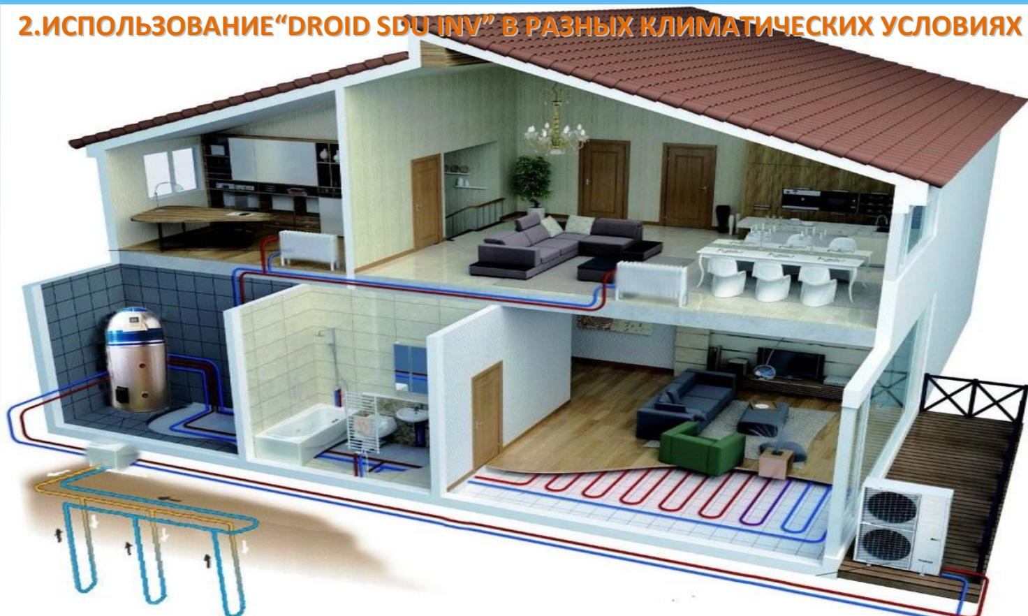
**Смешанный «гибридный» контур:** воздух- основной теплоисточник, ДХ геоконтур (35% от расчетной нагрузки) – используется в пиковые морозы.
